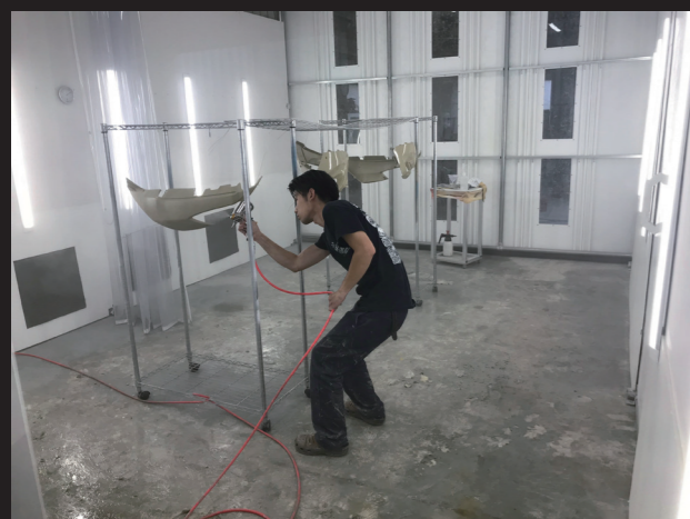
AM5-643 フル LED 照明で、ゴミの付きにくいダウンドラフト型のブースを完備。普通車なら軽く入る 6000×4000×3000
