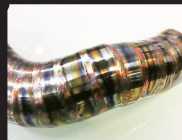
TIG 溶接 見える所の溶接に適しています
