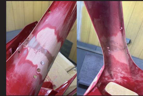
③溶接の巣穴をパテにて埋めていく
