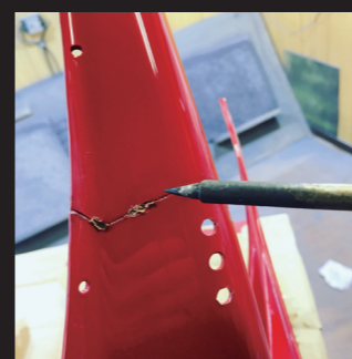
①割れてしまったカウルを溶接していく
