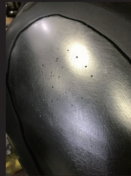
②凹んだ所を溶接して引っ張り出し、周りの表面とならす
