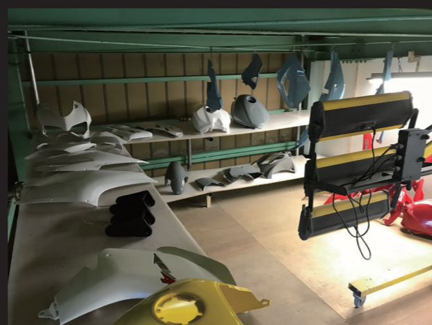
乾燥ブース 天候に左右されず、効率を UP させる事が出来る。
